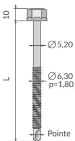
Vis autoperceuses pour fixation sur support métallique, support bois et pour couturage des profils
