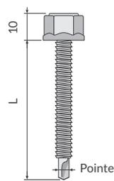
Vis autoperceuses pour fixation sur support métallique, support bois et pour couturage des profils
